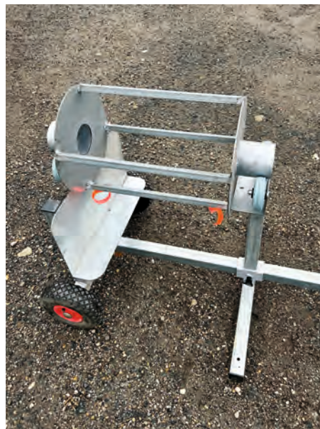
Dévidoir en place
